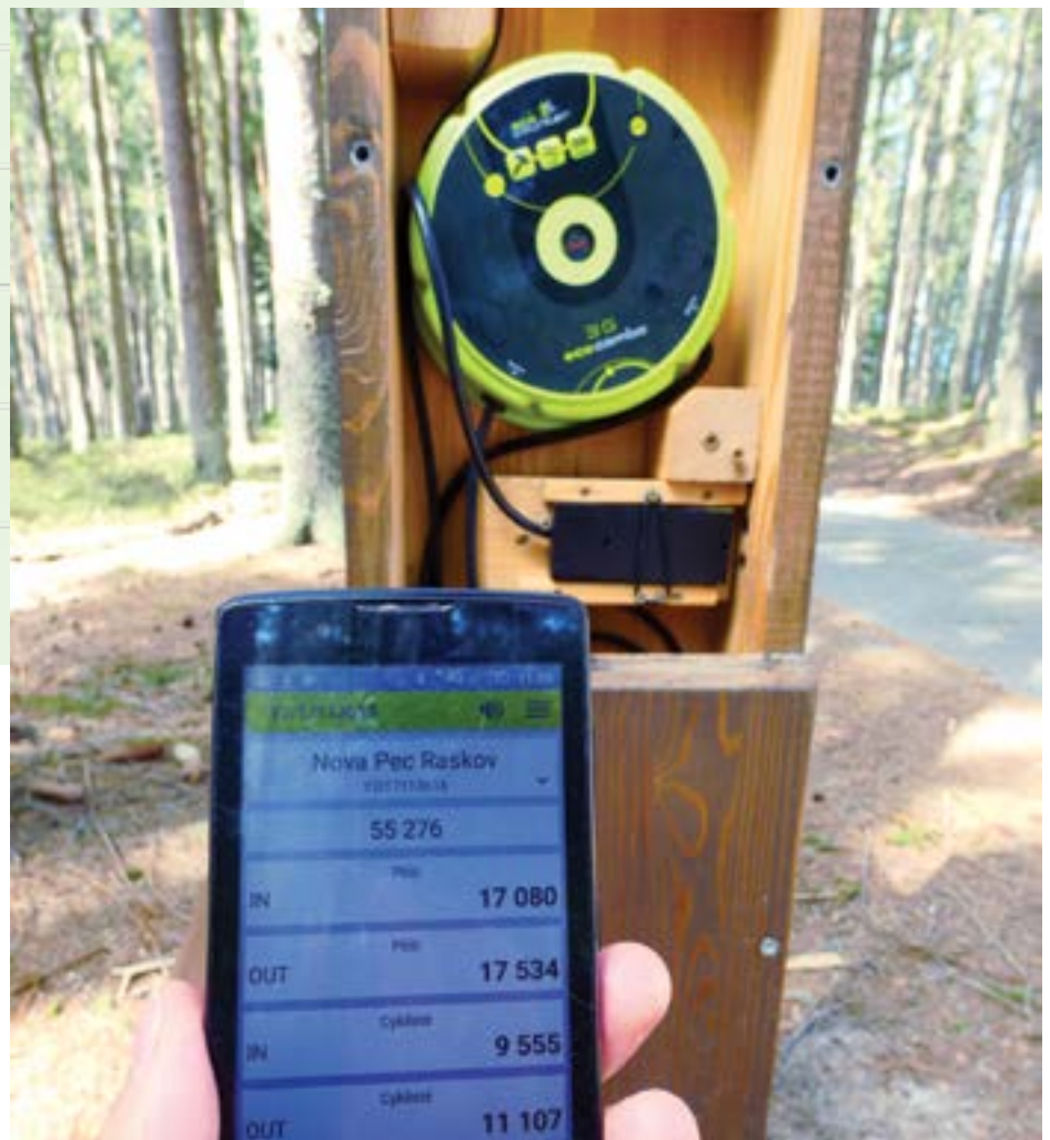
Mit einem Smartphone werden die Daten der Zählgeräte ausgelesen (Foto: Josef Štemberk)
