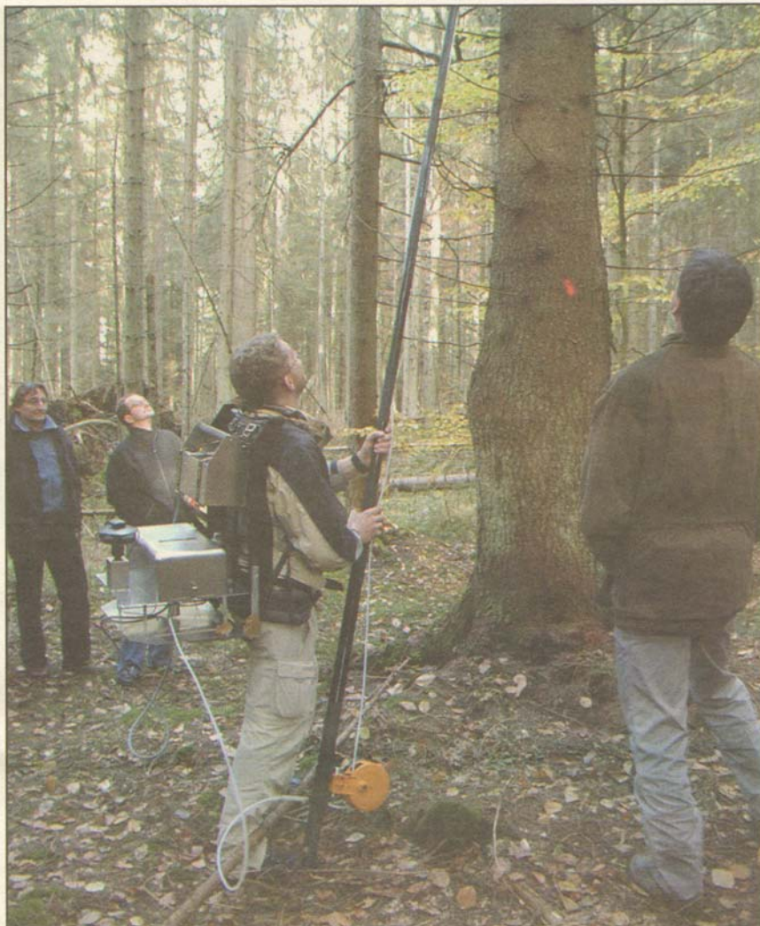
Früherkennung: Mit der „Künstlichen Nase“ lässt sich bereits in augenscheinlich gesunden Fichten der Borkenkäfer nachweisen.
