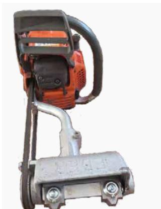
Das Rindenstreifenmesser kann als Aufsatz an Motorsägen angebaut werden.
