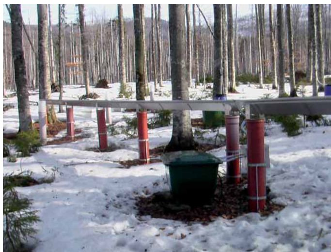
Messung der Niederschlagsintensität mit Messrinnen (Foto: Heiner Rall)
