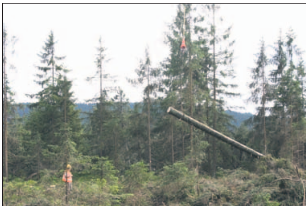
Um aus befallenen sensiblen Weichböden und Beständen mit bereits wertvoller Naturverjüngung das Borkenkäferholz so schonend wie möglich heraus zu transportieren, wurden heuer erstmals wieder ein Lastenhubschrauber und eine mobile Seilkrananlage mit 1,5 bzw. 3,5 Tonnen maximaler Traglast eingesetzt.
