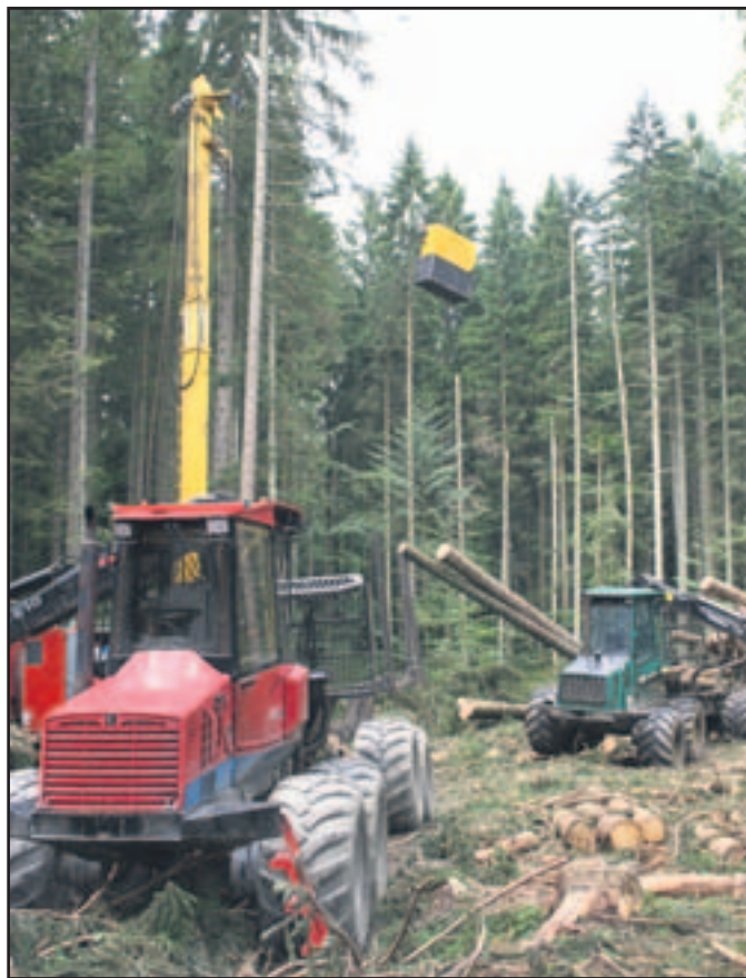
Um aus befallenen sensiblen Weichböden und Beständen mit bereits wertvoller Naturverjüngung das Borkenkäferholz so schonend wie möglich heraus zu transportieren, wurden heuer erstmals wieder ein Lastenhubschrauber und eine mobile Seilkrananlage mit 1,5 bzw. 3,5 Tonnen maximaler Traglast eingesetzt.
