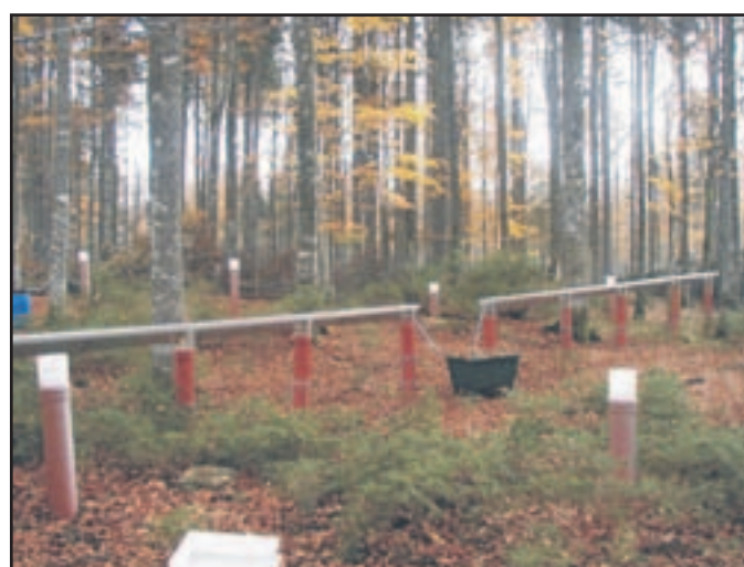
Auf Dauerbeobachtungsflächen werden sowohl im Waldbestand wie auf Freiland Luftschadstoffeinträge an Niederschlägen und im Bodensickerwasser gemessen.
