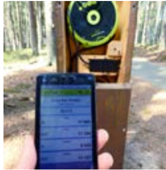
Mit einem Smartphone werden die Daten der Zählgeräte ausgelesen. Foto: Josef Štemperk
