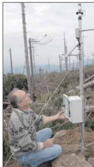
In den „Kyrill-Gebieten“ wurde ein solarbetriebenes Langzeitmonitoring eingerichtet.
