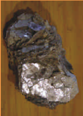
Pegmatite sind riesenkörnig. Die einzelnen Kristalle, wie dieser Muskovit-Glimmer, sind deshalb besonders gut zu erkennen.
