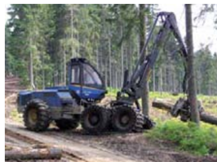
Käferholzaufarbeitung mit einem wendigen Rad-Harvester (Foto: Franz Baierl)
